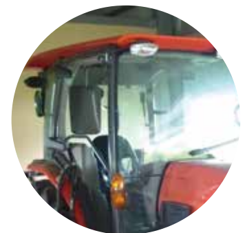
作業中に破損したキャビンガラス
