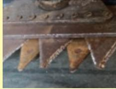
摩耗、破損があると刈残しが増える。使用前に注油することが長持ちさせるポイント。
